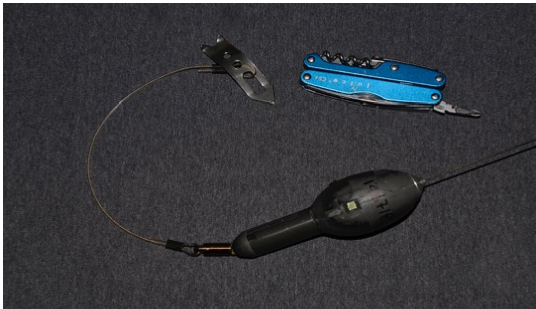
Figura 1. Marca MiniPAT modificada con dardo y un cable corto (12cm). (Wildlife Computers- https://wildlifecomputers.com/our-tags/minipat/ ) (Foto: ©Jonathan R. Green 2016).
